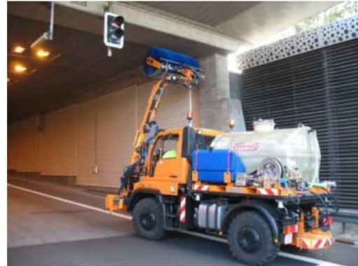
Das Waschen der Tunneldecke und -wände verbessert auch die Sicht im Tunnel. © Staatsbauverwaltung
