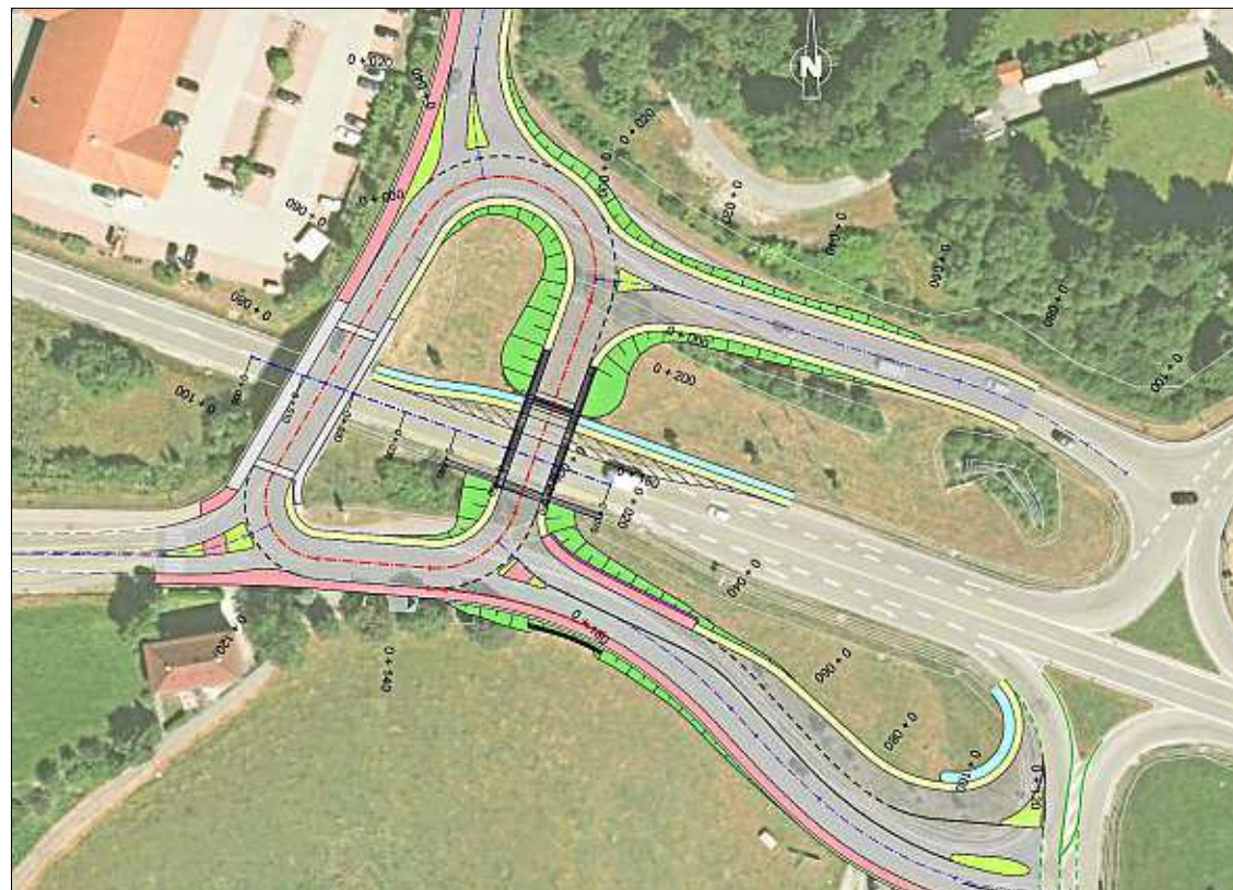
So soll der Knoten Waldkirchen aussehen: Wie in Freyung-Ort ist auch hier ein obenliegender Kreisverkehr geplant. – Visualisierung: Staatliches Bauamt Passau.
