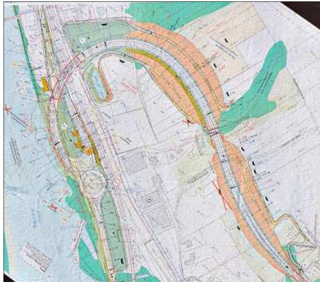
**Der Plan für die obere Baustelle.** Der Kreisverkehr ist erkennbar und dann der Straßenverlauf mit dem tiefen Einschnitt in den Hang.
