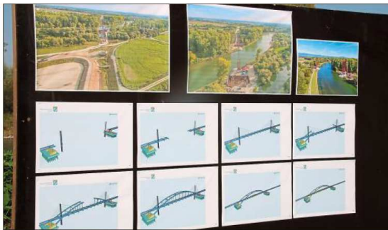
Hier ist dargestellt, wie nach und nach die Brückenteile zusammengesetzt werden.
